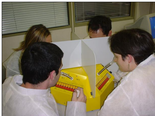
Photographie 1 : Séance de tests olfactométriques conforme à la norme AFNOR NF EN 13725
