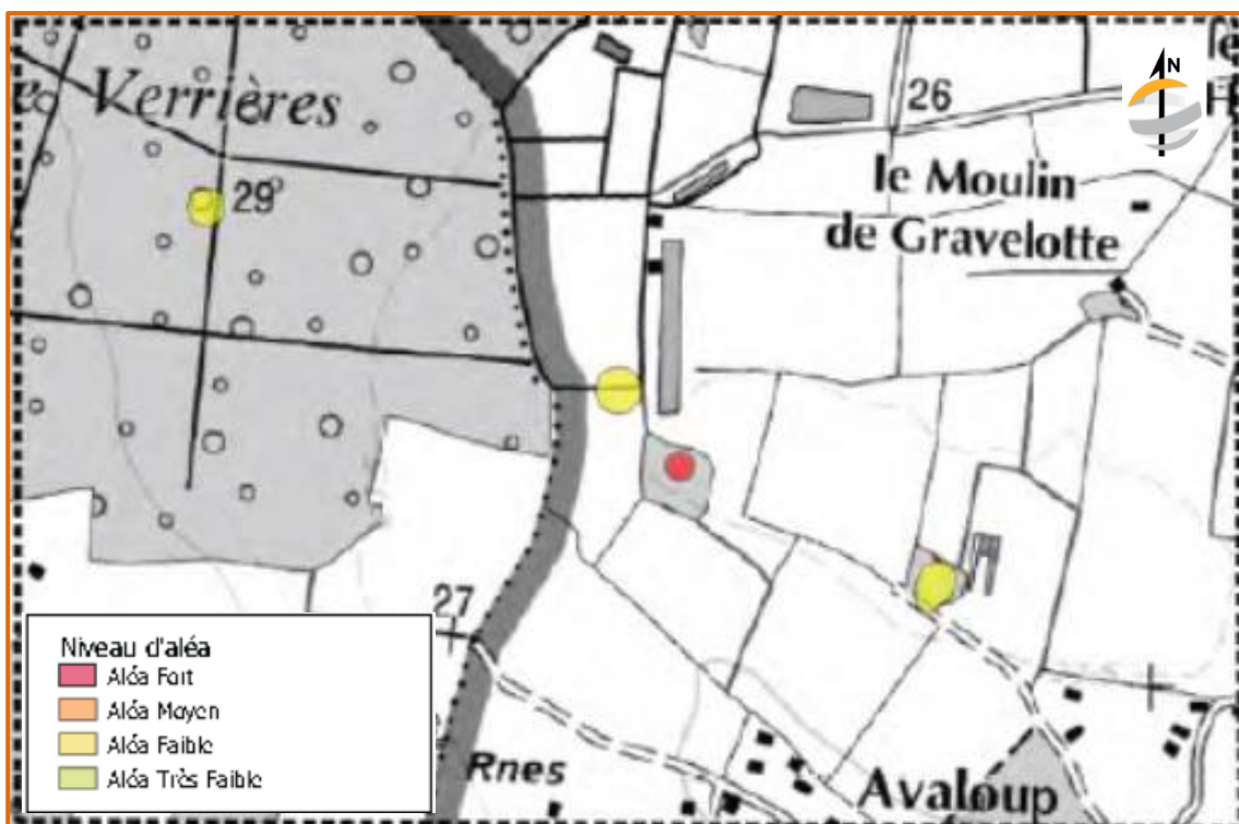
Cartographie des aléas mouvement de terrain – aléa effondrement localisé source Rapport BRGM/RP-69108-FR (2020) Annexe 1.d.
