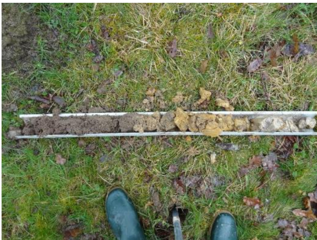
PHOTO 2 : SONDAGE AVEC 3 HORIZONS VISIBLES ET DISTINCTS (NON HUMIDE EN NOIR, REDOXIQUE ET ORANGE ET REDUCTIQUE EN GRIS) ©B. DESILLE
