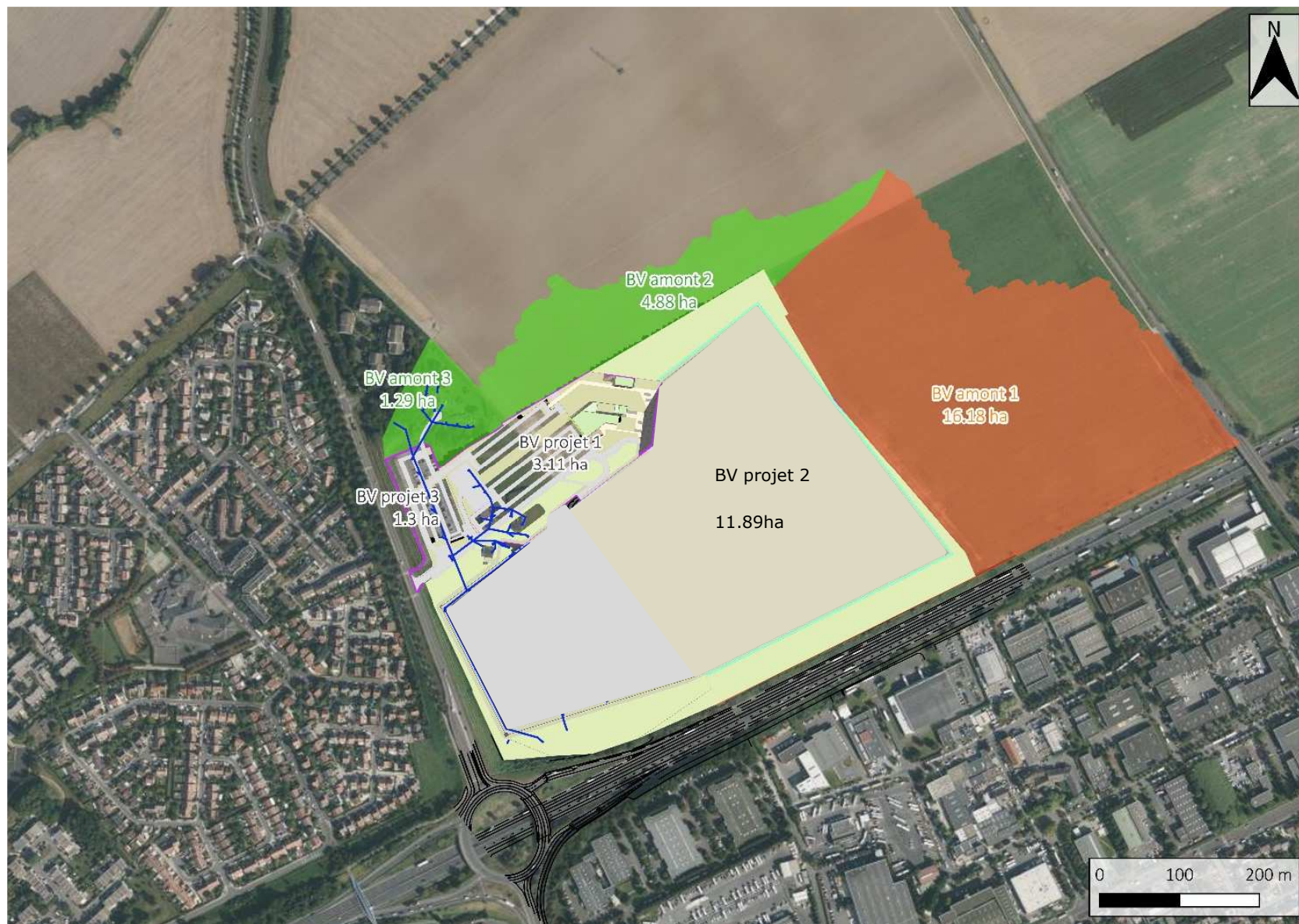
Figure 8 : Délimitation des bassins versants projet et bassins versants amont liés au périmètre à aménager
