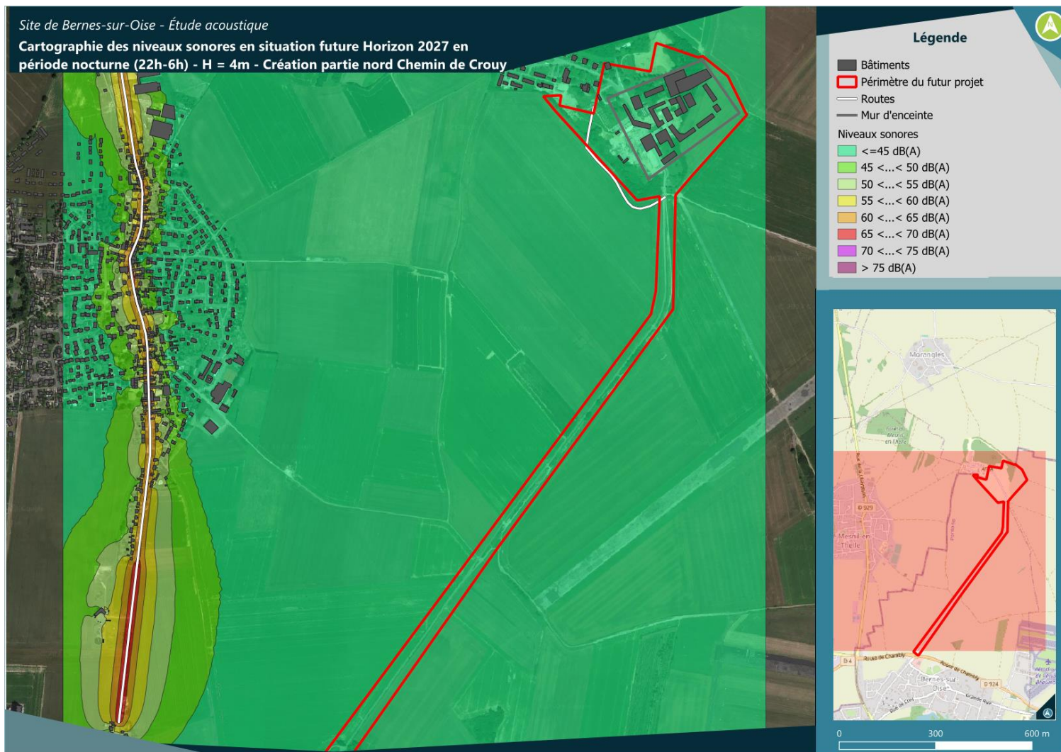
Figure 20: Cartographie des niveaux sonores (22 h – 6 h) - H = 4 m par rapport au sol – Situation future Horizon 2027 avec maison d’arrêt – Création partie nord Chemin de Crouy
