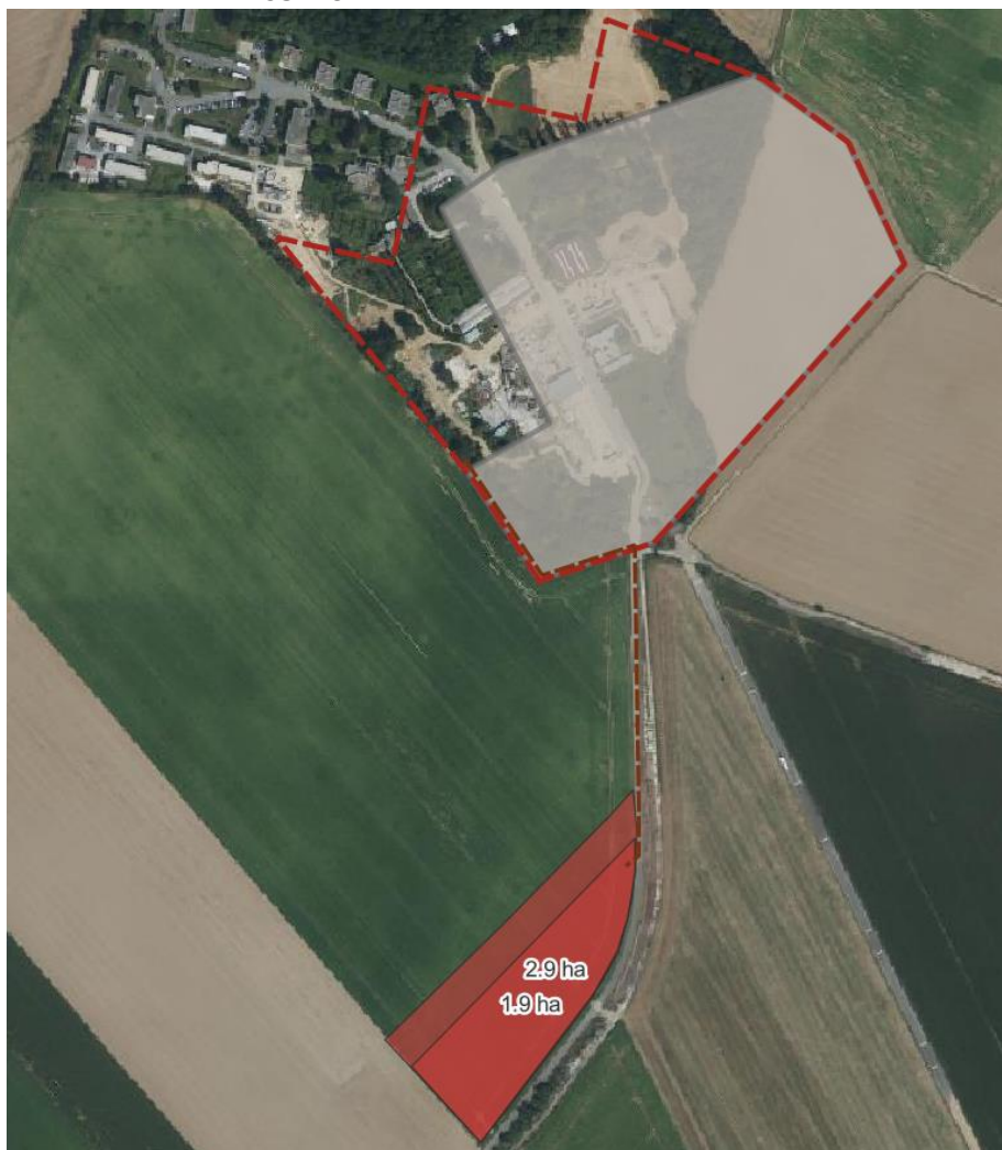
FIGURE 40 PROPOSITION D'IMPLANTATION D'UNE STEU DE TYPE EXTENSIVE , EN LAGUNAGE SIMPLE OU EN FILTRE PLANTE DE ROSEAUX
