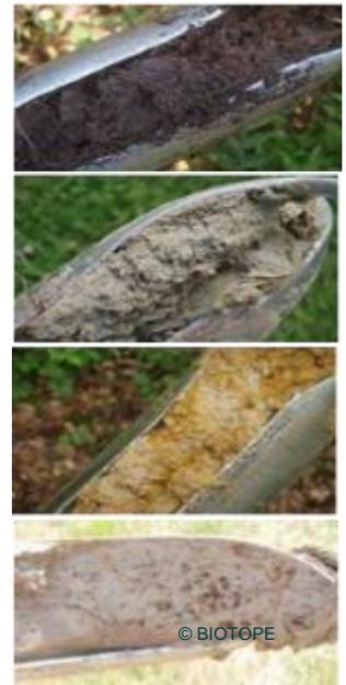
Il peut également être précisé que si aucune trace d'horizons histiques, rédoxiques ou réductiques n'apparaît dans les premiers 50 cm, il ne devient pas nécessaire de continuer plus profondément le sondage, puisque dans tous les cas le sol ne rentre pas dans le cadre des sols caractéristiques de zone humide selon les classes du GEPPA.
