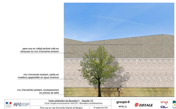
Figure 107 – pare-vue rehaussant le mur d'enceinte
