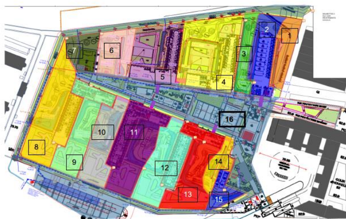
Figure 96 – délimitation des impluvium (source : DLE du projet)
