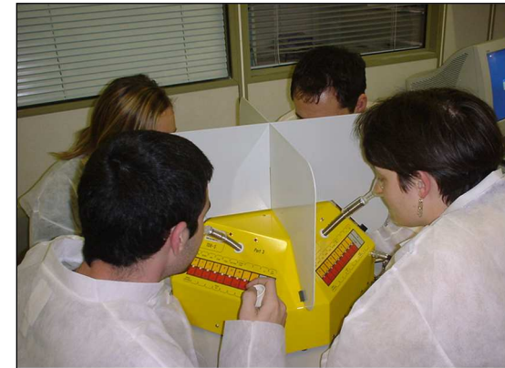
Exemple de Séance de tests olfactométriques conforme à la norme AFNOR NF EN 13725
