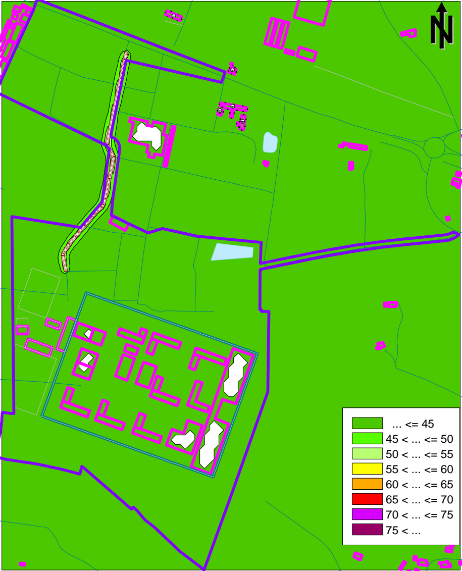
Cartographie des niveaux sonores (22 h - 06 h) - H = 4 m par rapport au sol - création accès EP - situation future avec maison d'arrêt
