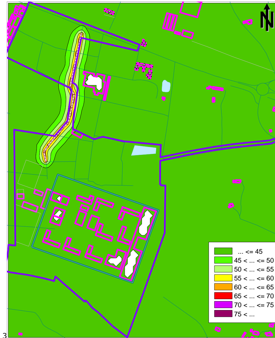
Cartographie des niveaux sonores (06 h – 22 h) - H = 4 m par rapport au sol - création accès EP – situation future avec maison d'arrêt
