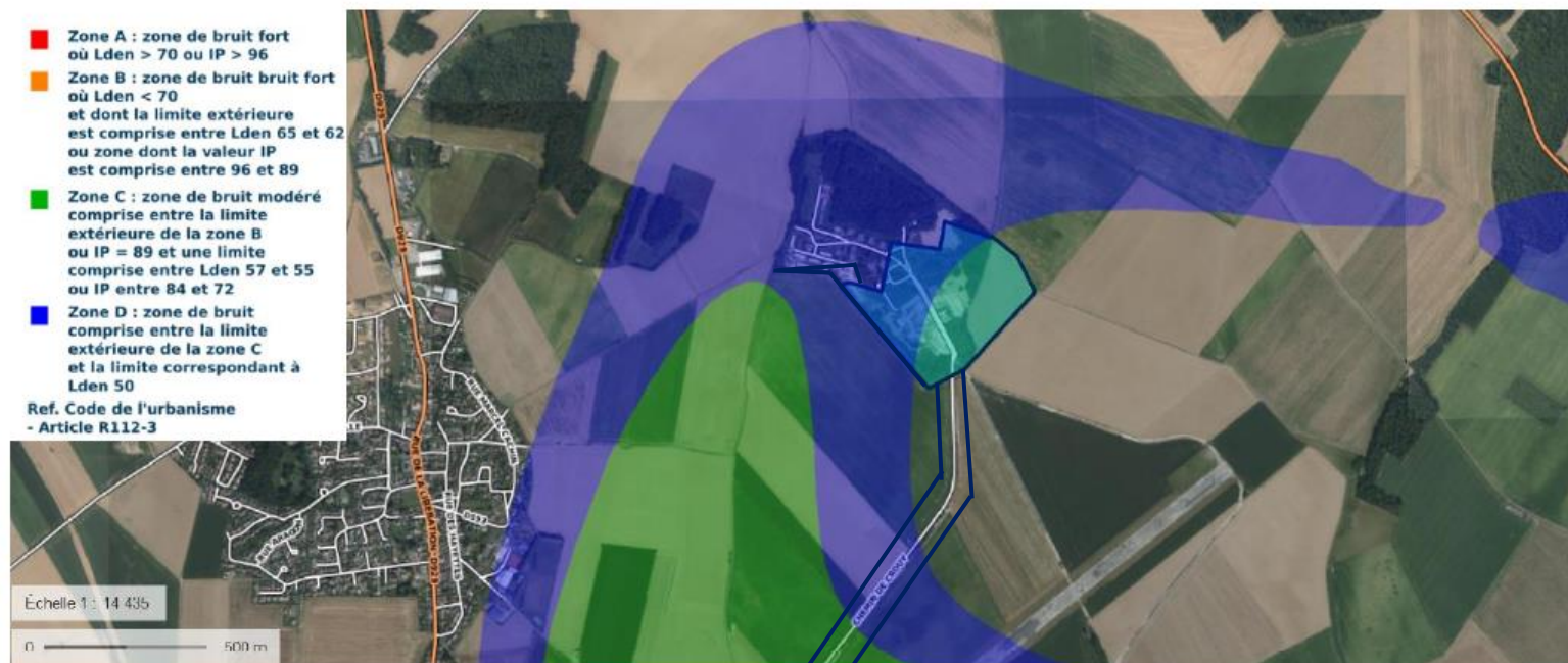
Figure 20 : Localisation du site d'implantation vis-à-vis du PEB de l'aérodrome de Persan (Source : PLU de Bernes-sur-Oise)
